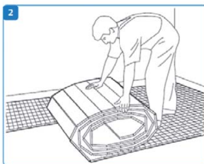
Pokládka izolační role/desky
