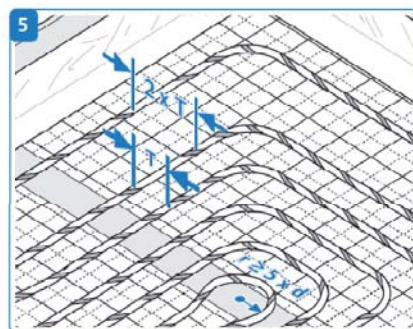
Pokládka potrubí v předepsané rozteči
